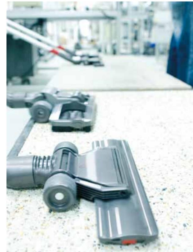
Dieser Test prüft die Verbindung zwischen Bodendüse und Teleskoprohr, indem die Bodendüse 10.000 Mal auf den Boden geschlagen wird.
