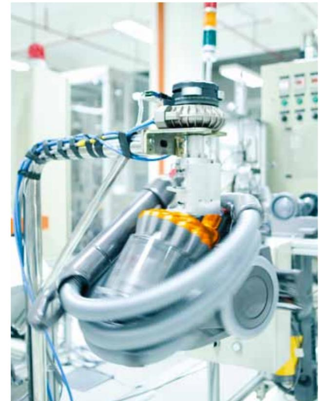
Dieser Test setzt den Tragegriff am Behälter Drehkräften aus, um das Tragen des Gerätes zu simulieren. Er wird 5.000 Mal wiederholt.
