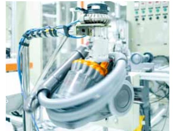
吸塵器的轉彎測試，吸塵器拖行5,000次。
