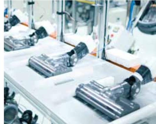
吸塵器吸頭模仿吸塵時動作，前往後退10,000次。
