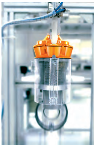
De stofreservoir-testmachine opent en sluit het stofreservoir 1560 keer.
