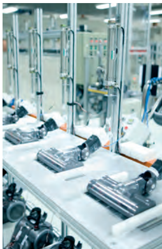
De vloerzuigmondnek-test simuleert 700.000 keer de duw-trek beweging tijdens het stofzuigen.
