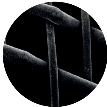
Filtre de gaze, échelle 1:50 Les espaces du filtre sont plus grands que les bactéries. Elles passent à travers.
