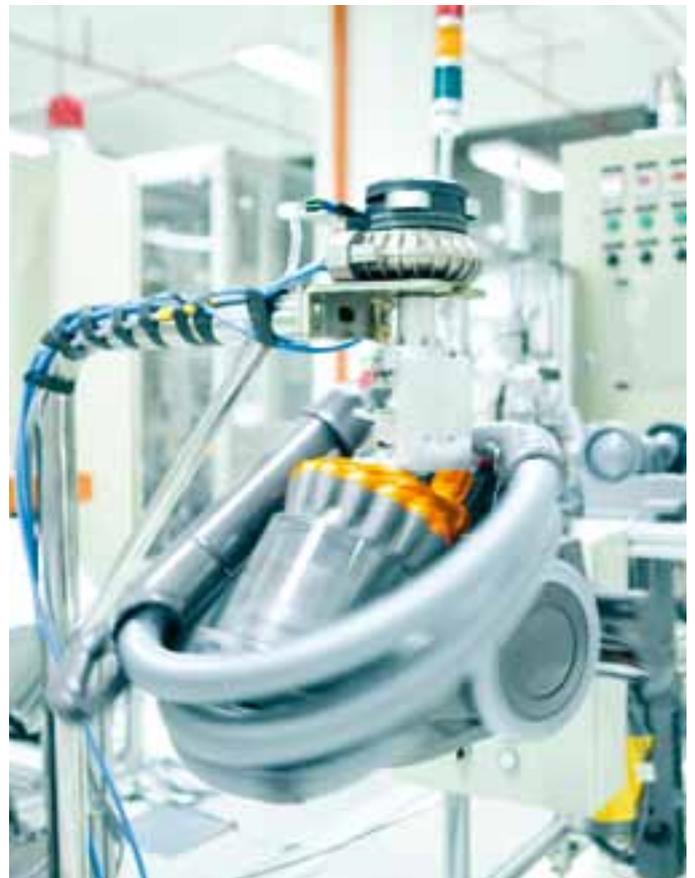
Dieser Test setzt den Tragegriff am Behälter Drehkräften aus, um das Tragen des Gerätes zu simulieren. Er wird 5.000 Mal wiederholt.
